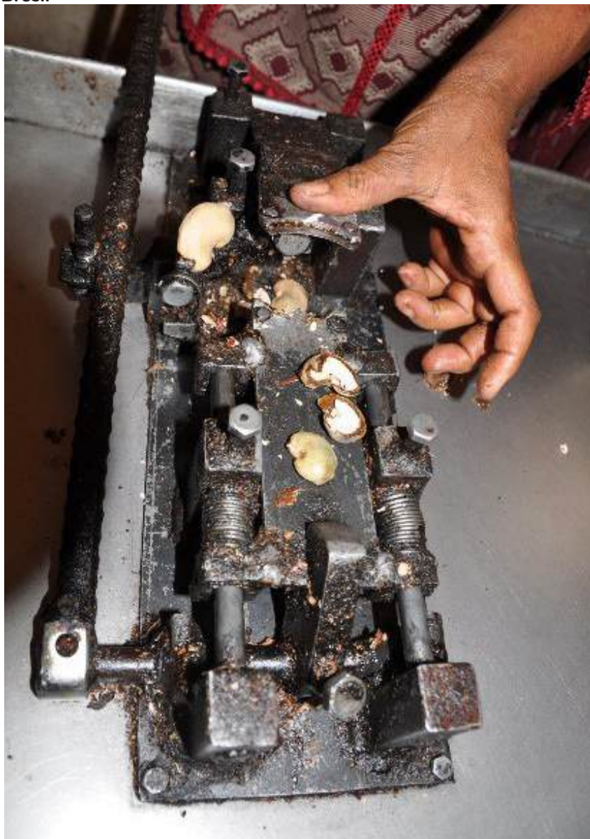
Figure 3 : Machines à décortiquer manuelle
