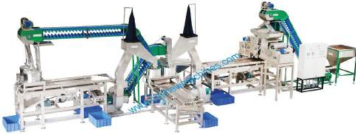
PILONNAGE DE NOIX DE CAJOU, SYSTÈME DE SÉPARATION ET DE SCOOPING/ CASHEW NUT SHELLING, SEPARATING AND SCOOPING SYSTEM
