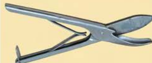
Material para abertura das castanhas : uma pinça calao
